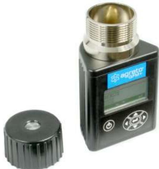
6. Schrauben Sie die Messkappe auf die Messzelle, bis der Druckindikator auf der Messkappe das gleiche Niveau wie der Messkappendeckel hat.
